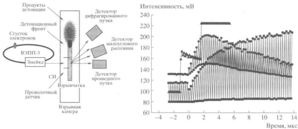
Рис. 1. Схема эксперимента и первичные экспериментальные данные, полученные во время взрыва (тротил + гексоген 50/50)
